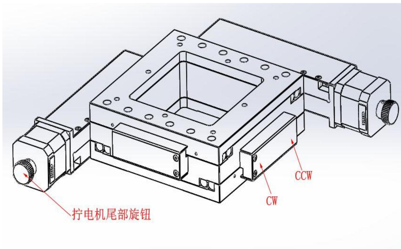
将顶板驱动至CW或CCW侧，则可分别窥见2个螺栓孔（共4个），用M6圆头内六角螺丝固定。
