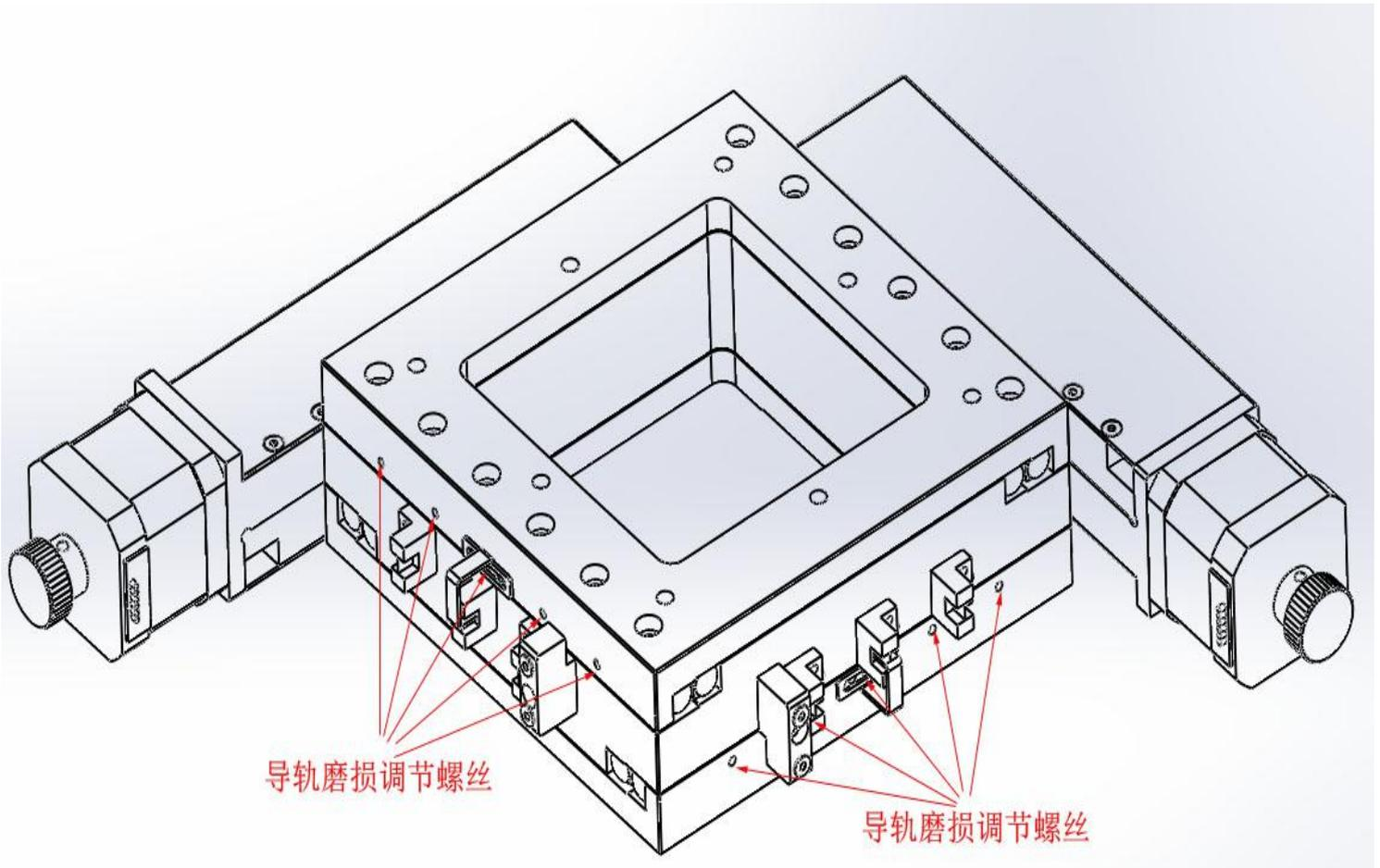
由于导轨的磨损，当滑台长期使用后产生了侧向间隙，可通过滑台侧边的交叉导轨间隙调整螺丝预紧使间隙消除。
