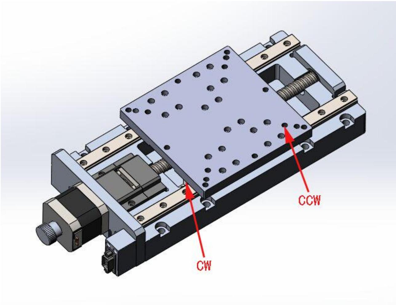
拧动电机尾部旋钮，将顶板驱动至CW或CCW侧，则可分别窥见安装螺栓孔（共6个）
