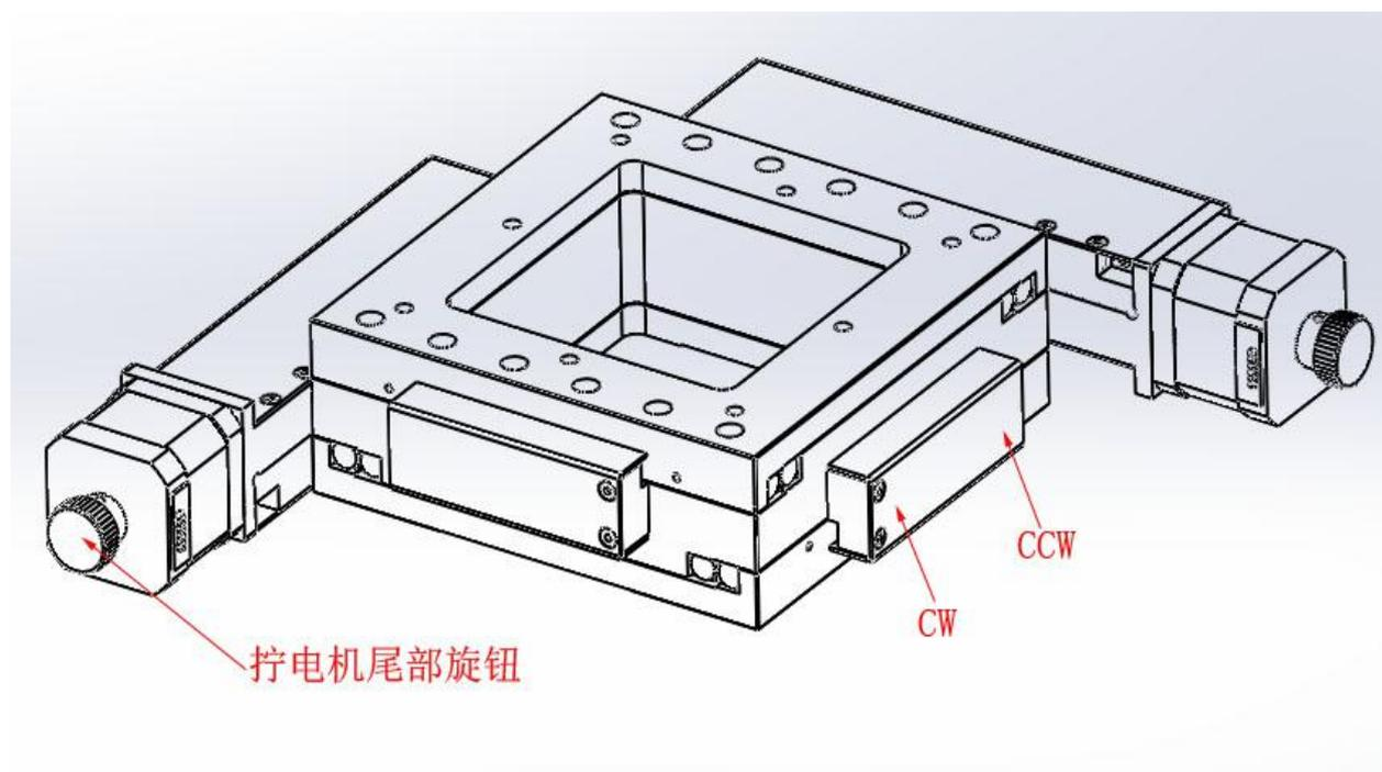
将顶板驱动至CW或CCW侧，则可分别窥见2个螺栓孔（共4个）。用M6圆头内六角螺丝固定。
